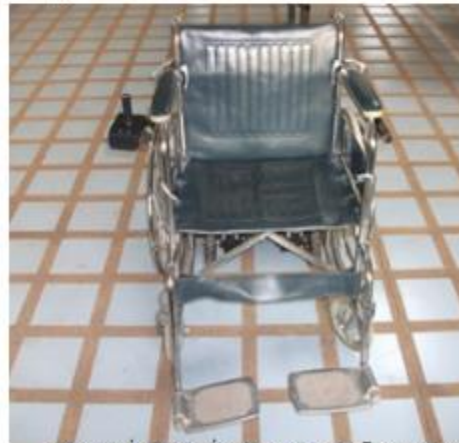
5) ชุดขับเคลื่อนไฟฟ้าเมื่อประกอบเข้ากับรถเข็นคนพิการ
