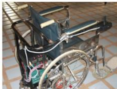
5) ชุดขับเคลื่อนไฟฟ้าเมื่อประกอบเข้ากับรถเข็นคนพิการ
